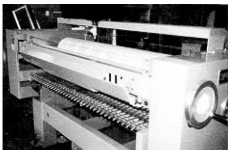
Fig. 4: Pantalla basculante protectora del acceso a la zona de alimentación (entrada de pieza)
